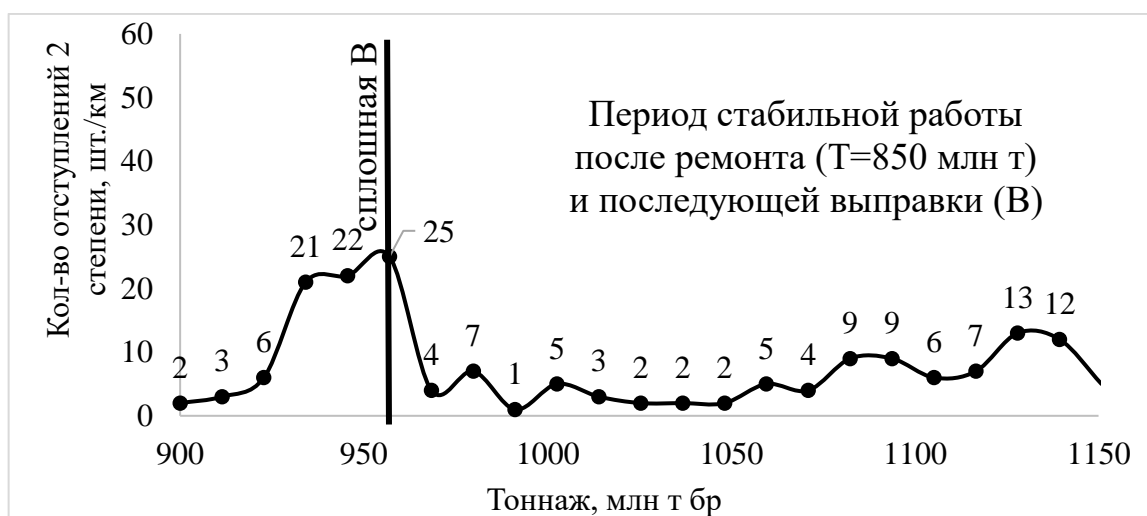
Рисунок 2 – Распределение количества отступлений 2 степени (без учета ширины колеи) в функции прошедшего тоннажа и выправочных работ на участке с наработкой более 850 млн т бр. после ремонта РС/РП
